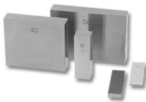
**Einzel Endmaß Stahl 175 mm DIN EN ISO 3650 mit Toleranzklasse: 1**
