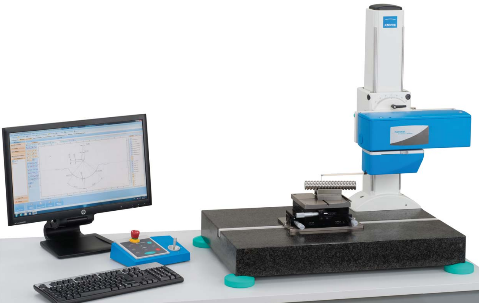
HOMMEL-ETAMIC surfscan mit Messtisch MT1 XYO und Prismenblock
