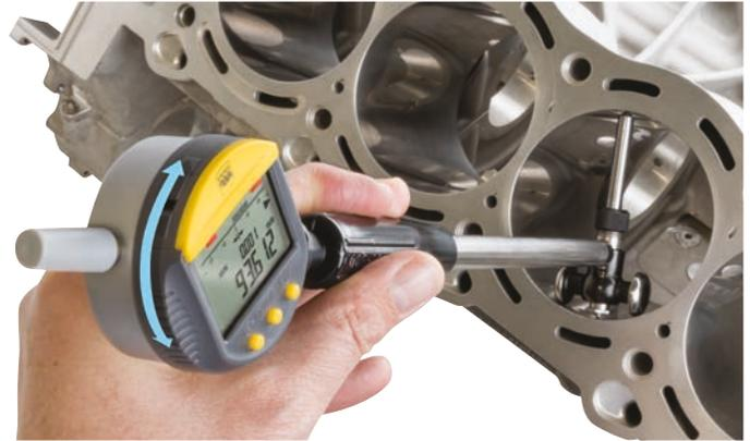
Kompatible Messuhren für TESA VERIBOR Bohrungsmessgeräte:
