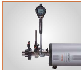
Kalibrierung unter Verwendung eines Innenmessgerät-Zubehörs (Modell C)
