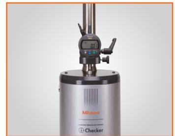
Kalibrierung unter Verwendung einer digitalen Messuhr
