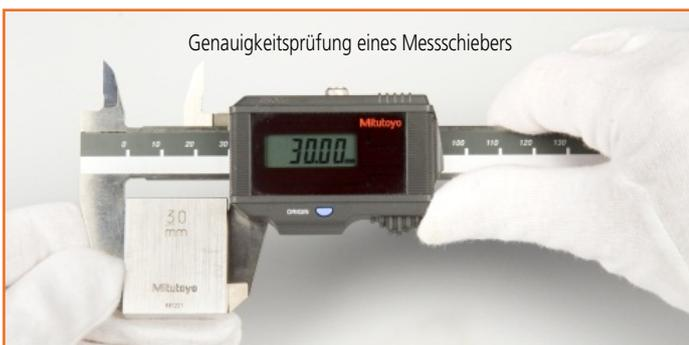
Genauigkeitsprüfung eines Messschiebers
