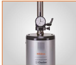
Kalibrierung unter Verwendung einer analogen Messuhr
