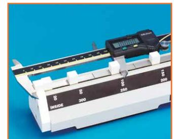
Genauigkeit des Messschiebers überprüfen (Außenmessung)
