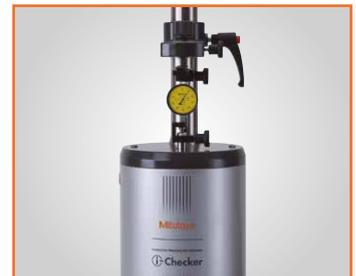
Kalibrierung unter Verwendung eines Fühlhebel-Zubehörs (horizontales Modell)
