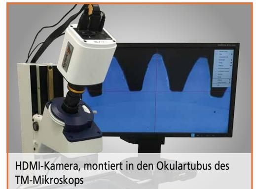
HDMI-Kamera, montiert in den Okulartubus des TM-Mikroskops
