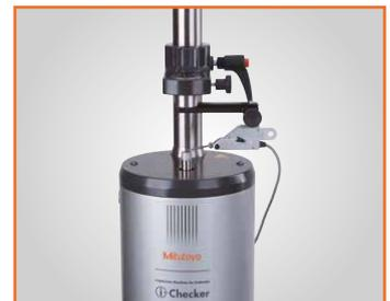
Mit Fühlhebel (induktivem Taster) überprüfen
