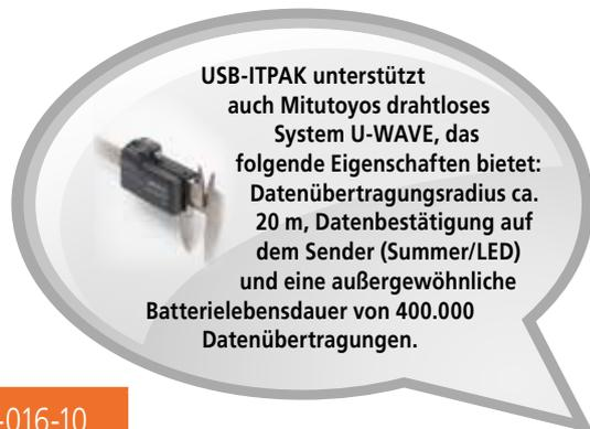
USB-ITPAK unterstützt auch Mitutoyos drahtloses System U-WAVE, das folgende Eigenschaften bietet: Datenübertragungsradius ca. 20 m, Datenbestätigung auf dem Sender (Summer/LED) und eine außergewöhnliche Batteriebensdauer von 400.000 Datenübertragungen.
