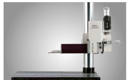
Optionale Autoset-Einheit, X-Achsen-Feineinstellung und digitale Nivelliereinheit, montiert auf dem Granitständer
