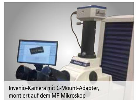
Invenio-Kamera mit C-Mount-Adapter, montiert auf dem MF-Mikroskop
