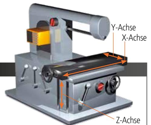
3-Achsen KA-200 COUNTER + drei Maßstäbe, max. effektiver Messbereich 3.000 mm
