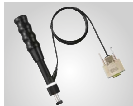
HLDL Schlaggerät UD-414 Für Verzahnungen, verschweißte Ecken usw.
